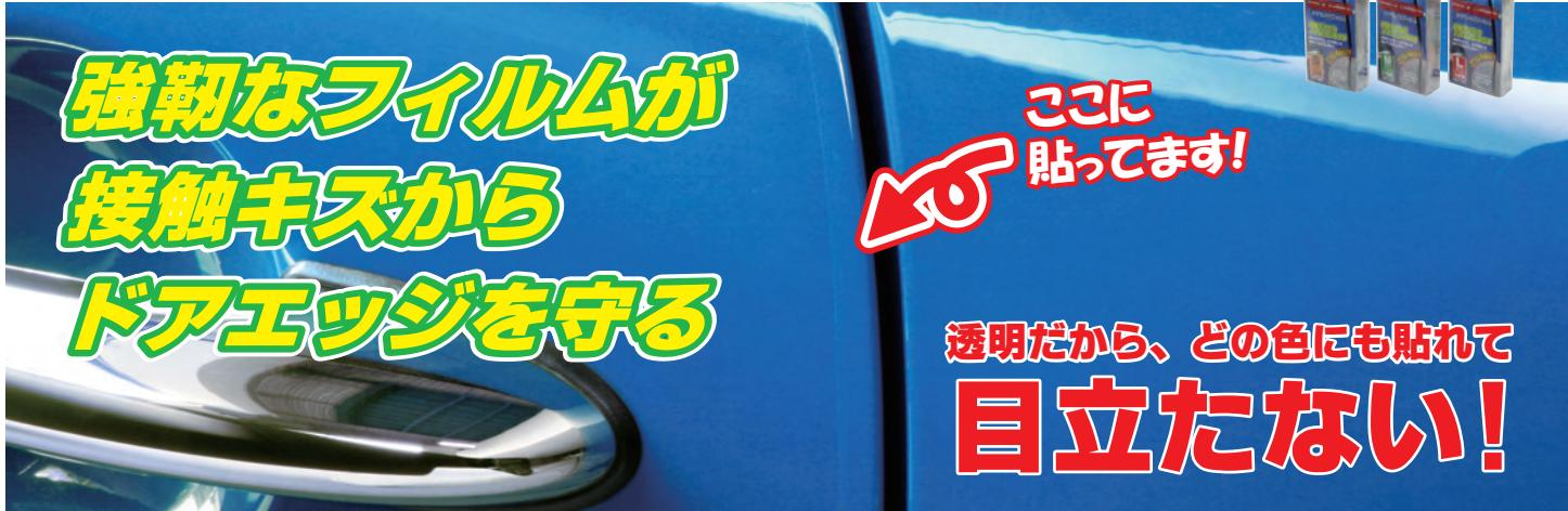
本製品は、強革な特殊フィルムでキズから愛車を守る、新しい発想のボディー保護アイテムです。フィルムは3層からなり、トップコートのエラストマー・ポリマーは、細かいキズを自己修復し、表面エネルギーによって黄ばみなどの汚れをフィルムから落とします。フィルム層には耐久性、耐摩耗性に優れたポリウレタンを採用。粘着層には塗装に適した粘着性と、取り除きやすさを追求した超高性能透明アクリル接着剤を使用しています。柔軟性の高いフィルムは、伸ばしても白濁せず、高い透明感を維持します。
